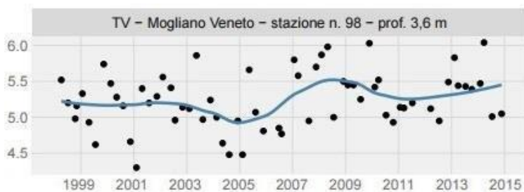
FIGURA 6-24: DIAGRAMMA PIEZOMETRICO RELATIVO ALLA STAZIONE IN FALDA LIBERA NEL COMUNE DI MOGLIANO VENETO
